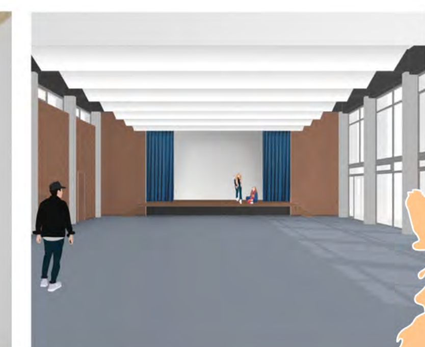
Aula im Mittelbau Die neue Akustikdecke nach bestehendem Vorbild integriert die neue Lüftung und Beleuchtung. Die Wandverkleidung wird auf-gearbeitet.
