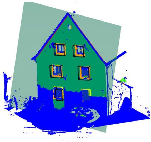
Abbildung 5: Visualisierung der automatisierten Segmentierung einzelner Fenster in schwarz umrandeten Bounding Boxes, welche wiederum zur Klassifizierung der Fenstereigenschaften durch Analyse der Transmission der unterschiedlichen Wellenlängen genutzt werden können. Eine durch die Fassadenpunkte gefittete Fläche (grün dargestellt) wird genutzt um die Tiefe von Fassade zu Fensterflächen als Eigenschaft zur Dämmungsermittlung auszugeben.
