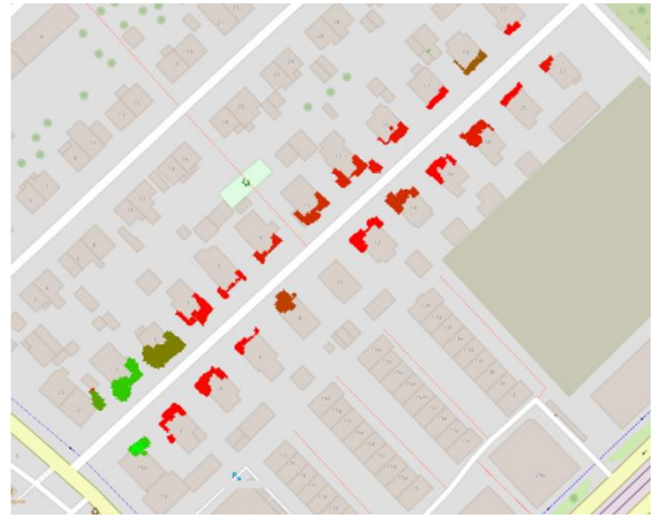
Abbildung 6: Da alle Messpunkte georeferenziert vorliegen, lassen sich die Ergebnisse aller Analysen automatisch auf eine Sanierungskarte projizieren, wie hier beispielhaft für die Fassadendicke dargestellt. Die Farbskala geht von Rot (dünne Fassade und somit vermutlich geringe oder keine Dämmung) nach Grün (dicke Fassade und somit vermutlich dicke und gute Dämmung).
