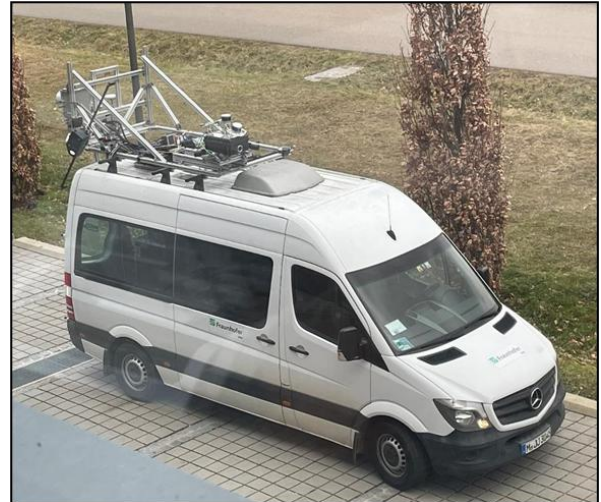
Abbildung 2: Messfahrzeug mit Sensorik montiert auf Dachträger aus Aluminiumprofilen. Integriert wurden mehrere LiDAR Systeme mit unterschiedlichen Wellenlängen, Thermal- und RGB-Kameras sowie eine Positioniereinheit.
