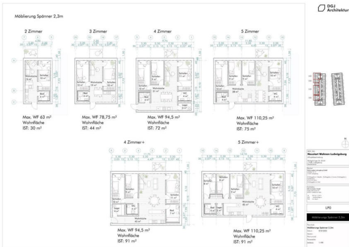
Abbildung 26: Spänner R 2.3 , Gebäudetiefe 18 m, Grundrisse Wohnungen.
