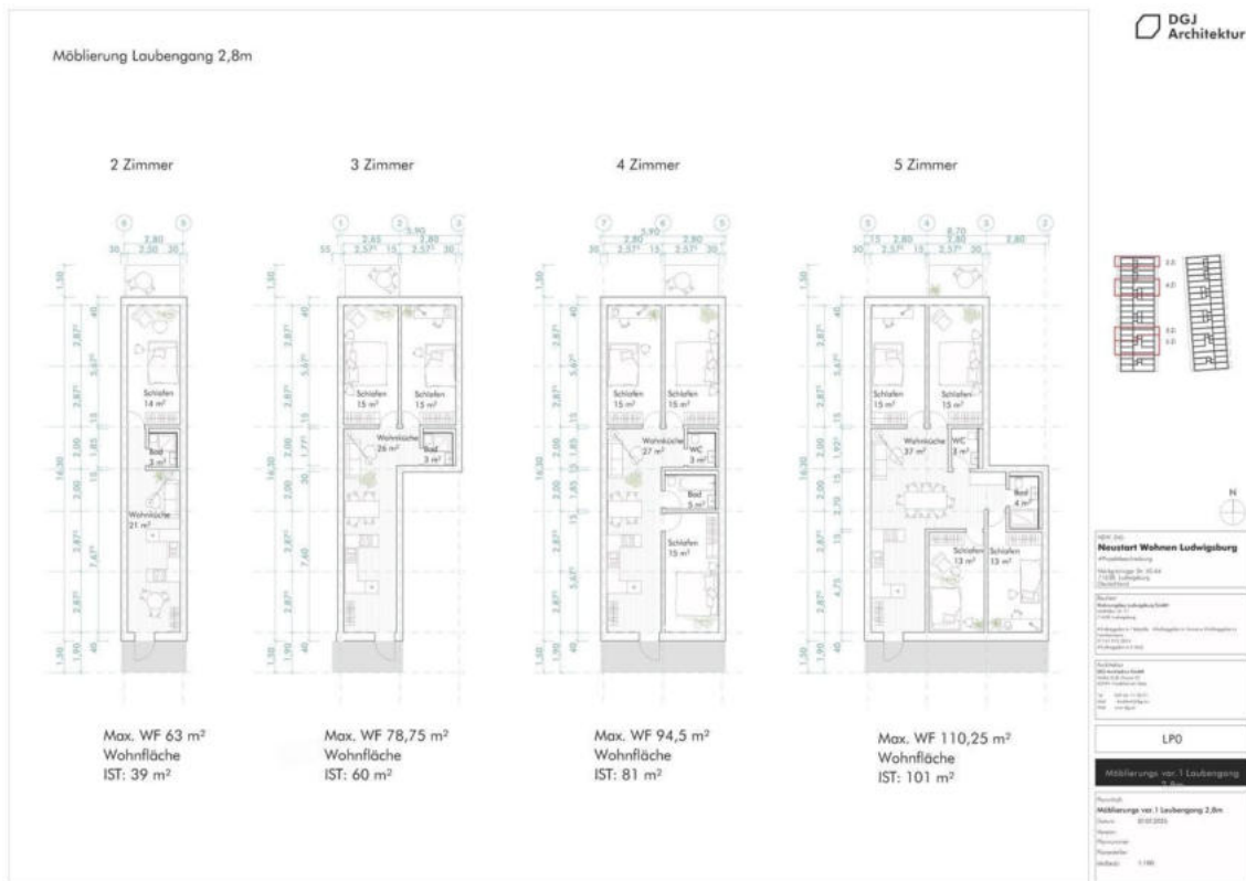
Abbildung 19: Laubengang R 2.8, Gebäudetiefe 16,3 m, Grundrisse Wohnungen.
