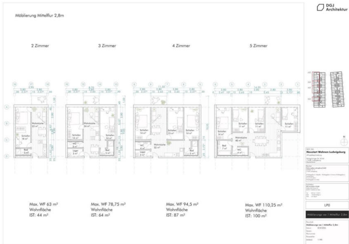
Abbildung 23: Mittelflur R 2.8, Gebäudetiefe 19,3 m, Grundrisse Wohnungen.
