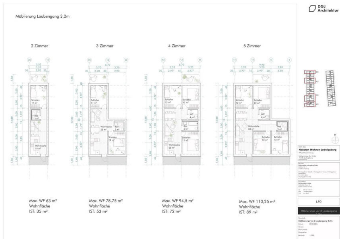
Abbildung 21: Laubengang R 3.2, Gebäudetiefe 12,8 m, Grundrisse Wohnungen.
