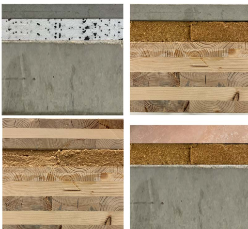
Einfache, nachhaltige Deckenaufbauten, alle mit Schallschutzniveau Basic+ (Holzbau Handbuch: Stahlbetondecke, EPS, Zementestrich oben links, Brettsper Holz, Holzweichfaser, Zementestrich oben rechts, Brettsper Holzdecke mit Holzestrich unten links, Stahlbetondecke, Holzweichfaser, Geopolymer unten rechts)
