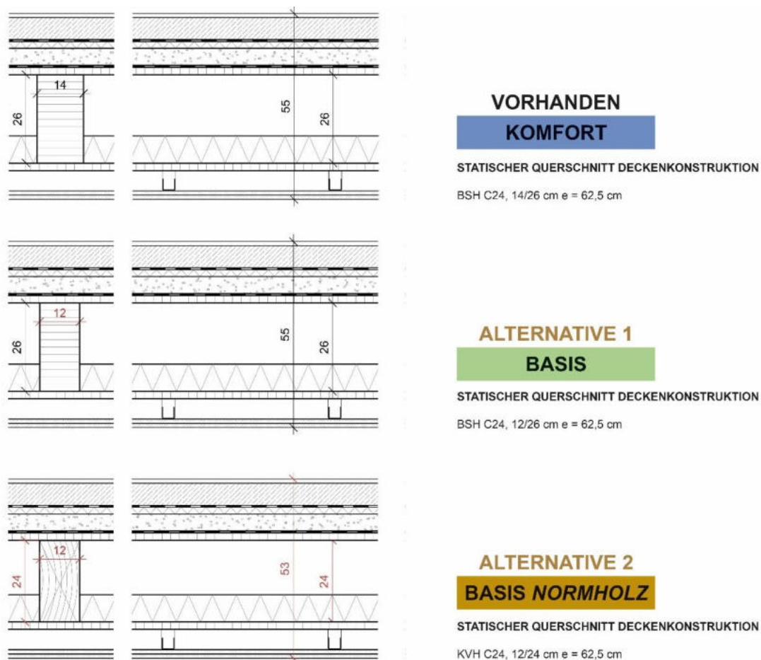
Abb. 33: Vorhandener statischer Querschnitt der Wohnungstrenndecken des Referenzobjekts 2 (Schwingungs- und Durchbiegungsniveau „KOMFORT“) sowie Konstruktionsalternativen 1 und 2 (Schwingungs- und Durchbiegungsniveaus „BASIS“ bzw. „BASIS NORMHOLZ“)
