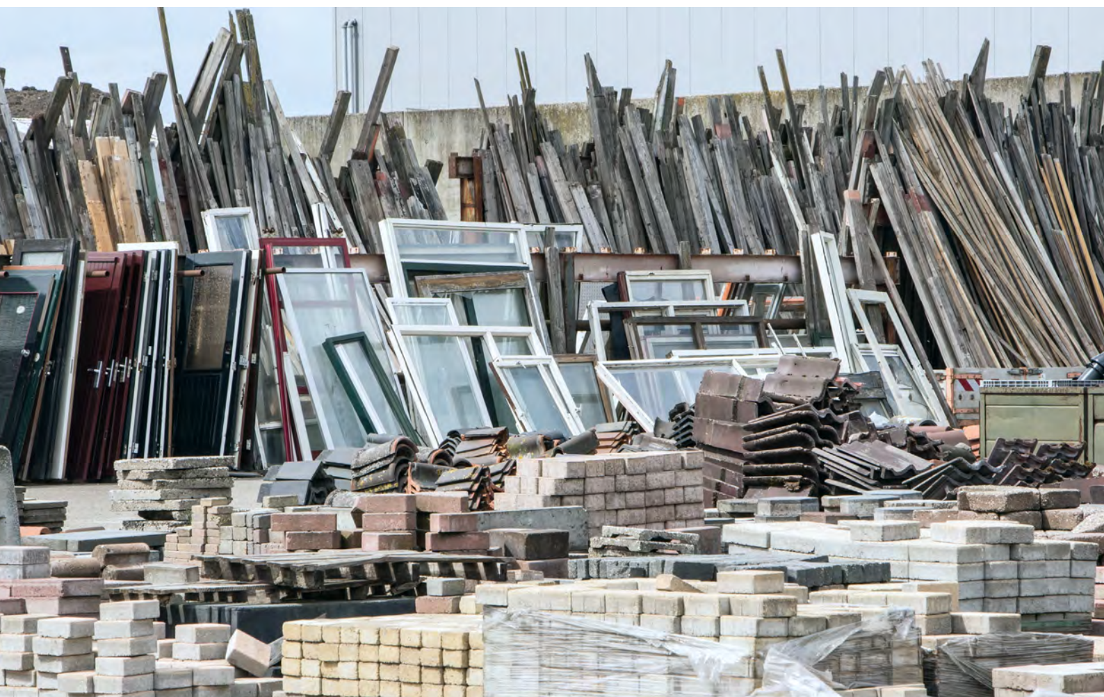
Zwischenlagerung von Bauteilen zur Wiederverwendung
